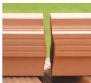
und einen sogenannten „Schablonschnitt“, d.h. die Schnittkante des Ziegels ist nicht genau plan sondern leicht gewellt, was eine bessere Verzahnung der Steine untereinander herstellt.
