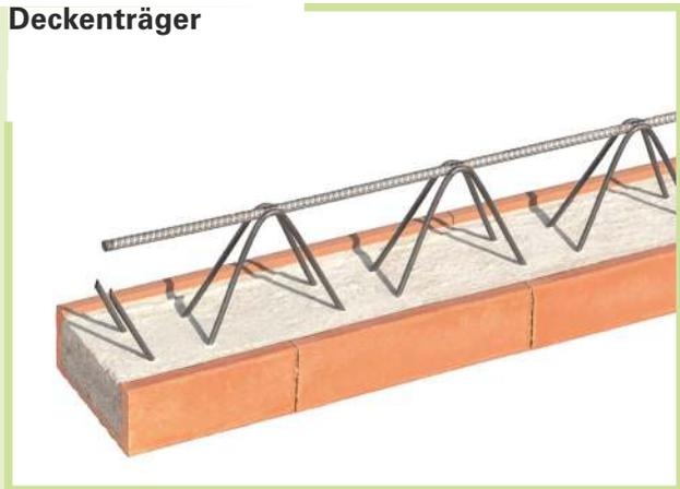
Der Deckenträger besteht aus einem in eine Ziegelschale einbetonierten Filigran-D-Gitterträger nach bauaufsichtlicher Zulassung Z-15.1-148. Die Fußleiste hat i.d.R. eine Breite von 16,5 cm und eine Höhe von 7,5 cm. Zur Anpassung an örtliche Gegebenheiten kommen auch Deckenträger mit einer Breite von 14,5 cm oder 25,0 cm (sog. „Füllträger“) zum Einsatz. Die Höhe des Gitterträgers richtet sich nach dem Deckentyp und kann zwischen 10 cm und 24 cm variieren.
