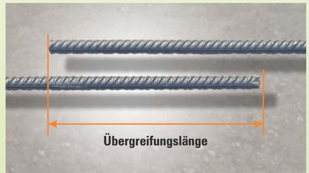
Ringanker und gegebenenfalls Querrippen erfordern eine Bewehrung mit zusätzlichem Betonstahl. Art, Menge und Übergreifungslängen sind im Verlegeplan angegeben und müssen exakt eingehalten werden, um die Standsicherheit der Decke zu gewährleisten. Fiedler Ziegel-Einhängedecken mit Aufbeton  $\geq 6$  cm werden in der Regel mit Q188-Matten flächig bewehrt.
